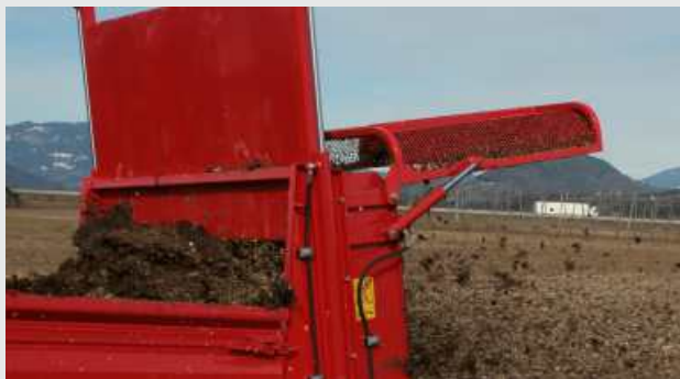
ORION 50: hidravlični dvig zadnje zaščitne mreže in stene.
