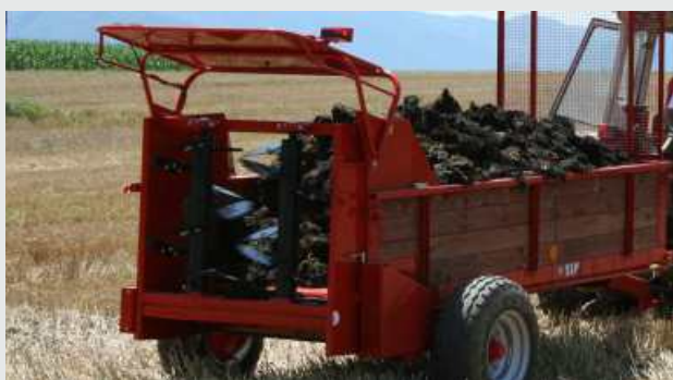
Trosilna naprava ORION-a 35R z zadnjo zaščito in parom pokončnih valjev s segmenti zagotavlja enakomeren in fini raztros. Hitro jo lahko odstranimo ter trosilnik uporabimo kot prokolico.
