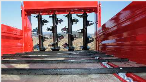
ORION 50: verižni transporter ima dve verigi 10 x 31 iz jekla visoke kvalitete in kovinske stranice na katere je možno dodati poviške.
