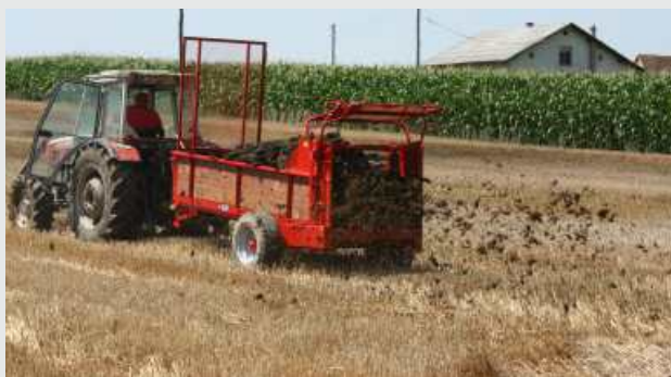
ORION 35R ima mehanski pogon verižnega transporterja s 4-stopenjsko nastavitvijo hitrosti pomika. Serijsko ima dodano zadnjo stranico, ki jo namestimo v primeru, kadar snamemo trosilno napravo in trosilnik koristimo kot klasično prikolico.
