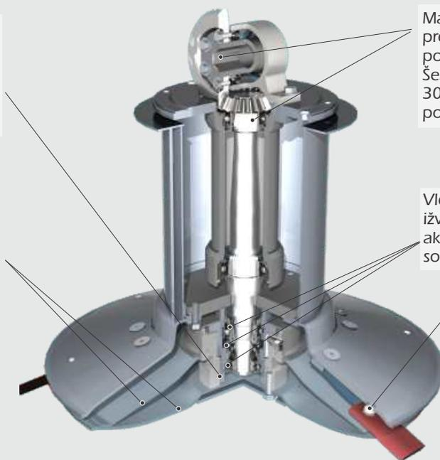
Masiven žobniški par zagotavlja prenos vrtilnega momenta prek pokončne gredi na krožnik z noži. Šestroba pogonska gred dimenzije 30mm je iz kvalitetnega poboljšane jekla.
