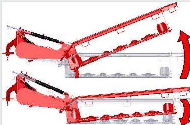
Dvigovanje in spuščanje kosilnega grebena se vrši s hidravličnim čilindrom, pri tem ravnanje s traktorskimi rokami ni potrebno. Spuščanje kosilnega grebena je enakomerno in ne poškoduje travne ruše.
