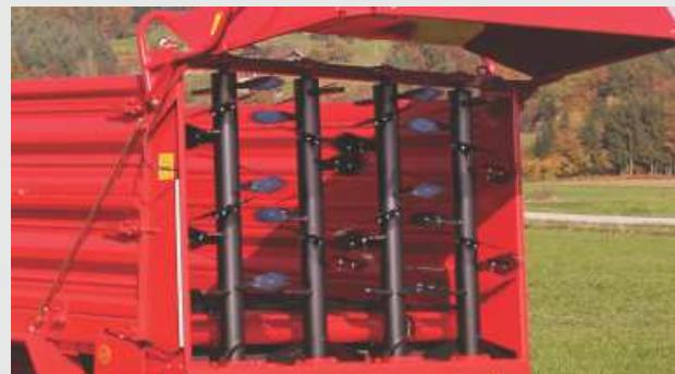
Trosilnik je lahko opremljen z vertikalno trosilno napravo s štirimi valji, maksimalno širino trošenja 10 m ali s širinsko trosilno napravo, ki omogoča trošenje do 24 m.
