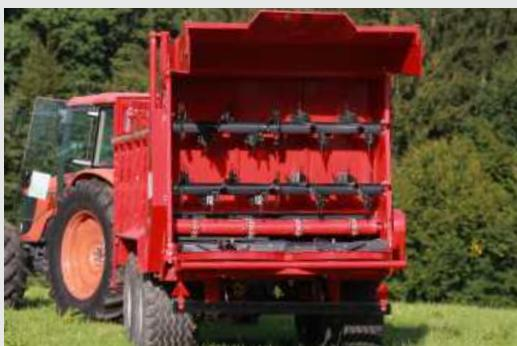
ORION 100TH PRO ima širinsko trosilno napravo, ki ima dva stopnicasta horizontalna valja, na katerih so pritrjeni zamenljivi prsti. Pod valjema sta dva rotorja, ki omogocata enakomerno in fino trošenje do širine 24 m.
