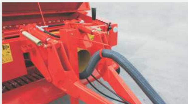
Univerzalno zasnovan priklop je možno enostavno prilagoditi za priključitev na spodnji ali zgornji priklop traktorja. Hidravlični valj na priklopu omogoča dodaten dvig čelotnega prednjega dela prikoliče, za lažji dovoz krme na silos.
