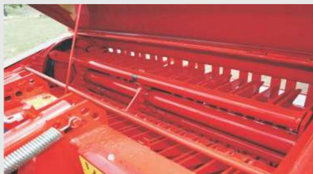
Enodelna vrtljiva potisna naprava s štirimi polnilniki enakomerno transportirajo krmo v tovorni prostor.
