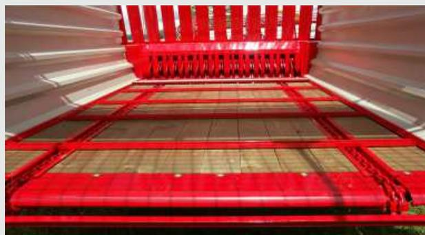
Verišni transporter z dvema verigama. Strgalne letve so iz kvalitetnega materiala odpornega na upogib in zvijanje.
