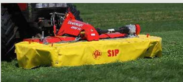
Kosilni greben kosilnice SILVERCUT je na vsakem disku varovan z vmesno prirobnico tako, da le ta pri preobremenitvah diska varuje greben pred poškodbami. Izvedba zagotavlja enostavno menjavo varovalnih čepov in brezhibno nadaljnjo rabo stroja.
