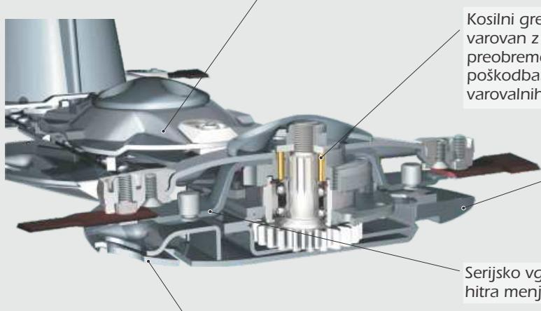
Zaobljeno oblikovani drsniki omogočajo veliko nalezno površino. Kovani drsniki iz visoko protiobrabno odpornega borovega jekla, zagotavljajo dolgo zivljensko dobo in visoko zaščito tako grebena kot diskov.
