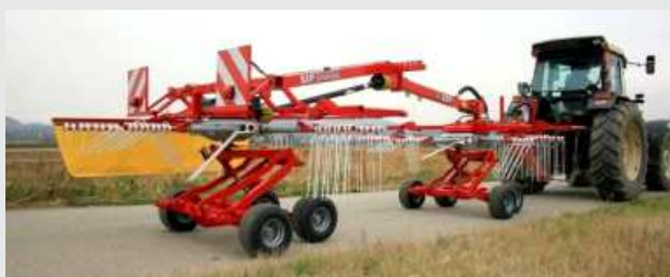
Za prehode čez zgrabke in transport se zgrabljalik STAR 600/20 hidravlično dvigne 470mm.
