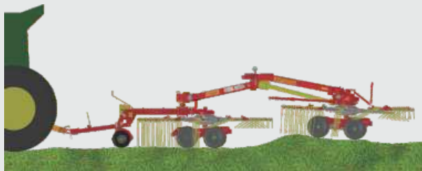
Idealno kopiranje terena - členkasto vpetje zadnjega rotorja s tandem podvozjem. Dodatna sprednja tipalna kolesa: - podporno kolo za delo v ravnini, - dvojno podporno kolo za delo na nagibu.
