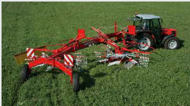
STAR 700/22: Kljub veliki dolžini stroja izjemna okretnost stroja. Krmilni mehanizem koles omogoča sledenje traktorju v zavojih.
